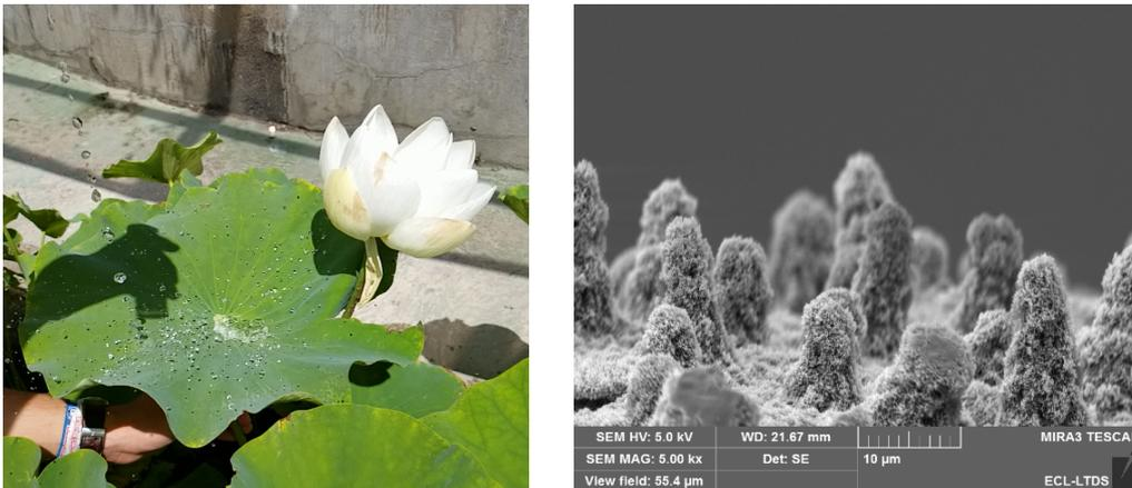
Figure 1 : Photographie d'une feuille de Lotus (*Nelumbo nucifera*) montrant un comportement de déperlage de l'eau (Botanical garden of Lyon, @Mathilde Catherin & Yann Bami Chatenet, LTDS) ; Image SEM (Scanning Electron Microscope) d'une feuille de Lotus (échelle micrométrique).
