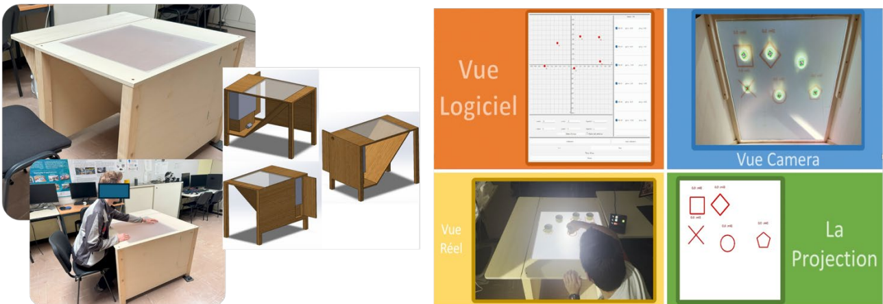
Prototype V1 de table de réalité augmentée projective pour l'analyse sensorielle.
