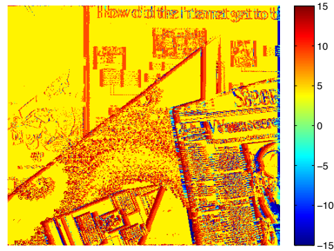
Figure 14: Carte de disparité estimée par notre algorithme à M -chemins (PSNR=27.39 dB ; H=1.85 bpd).
