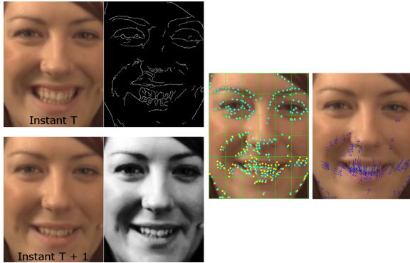
Figure 3: Processus d'extraction des points d'intérêts et des flux optique sur le visage.
