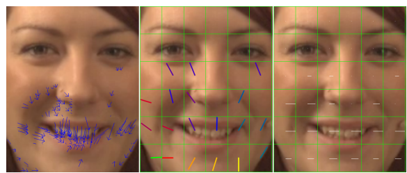
Figure 5: Création du modèle de direction (b) et du modèle de magnitude (c) à partir des flux optiques (a).
