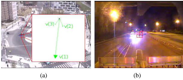
Figure 6 – Exemples de fausses alarmes. (a) Oubli lors de l'apprentissage. Les trois vecteurs du modèle épars ont été représentés en vert. Pour chacun des vecteurs la direction est donnée par l'orientation apprises alors que la norme caractérise le poids associé. (b) Problème d'ouverture. Le flot optique est orthogonal à la bordure du faisceau de lumière, donnant des résultats complètement faux.
