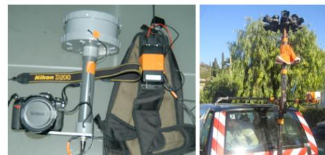
Figure 2 – Dispositifs de prises de vues utilisés, pédestre mono-caméra (à gauche), véhicule multi-caméras (à droite)
