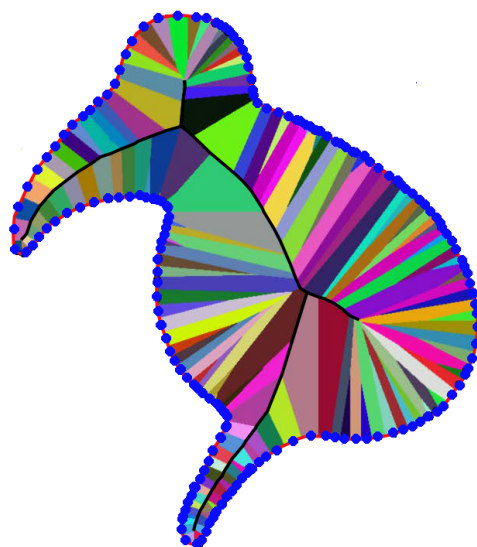
FIGURE 2.11 – Exemple de squelette de Voronoï. Le bord de la forme est constitué par la ligne rouge, les points échantillonnés sont en bleu et le squelette en noir (Dardenne et al. (2009)).
