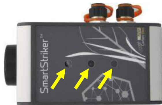
FIGURE I.4 – La camera Carbon Bee vue de face. Les trois flèches jaunes indiquent les positions des objectifs des trois capteurs. Source : Carbon Bee AgTech.
