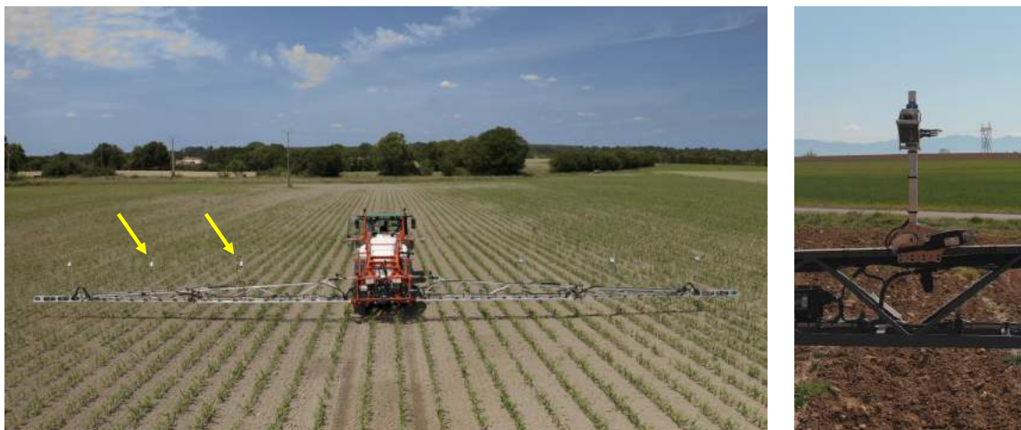
(a) Vue d'ensemble du tracteur équipé de rampes. Les flèches jaunes indiquent la position de deux caméras.
