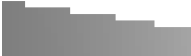
Fig. 3.13.: Crénelage due à la basse résolution de la carte des profondeurs.
