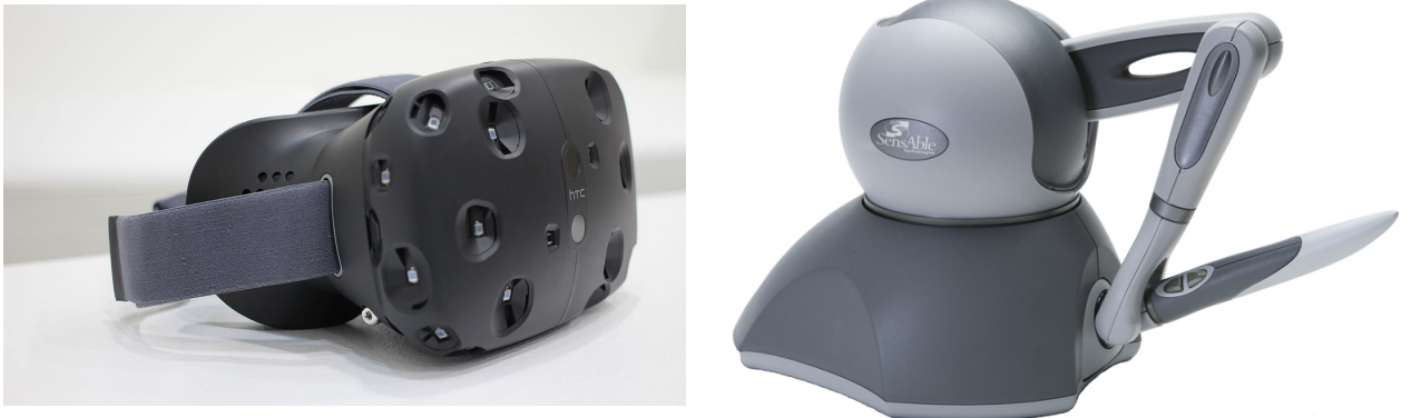
FIGURE 6 – casque de réalité virtuelle HTC Vive et bras haptique Phantom Omni
