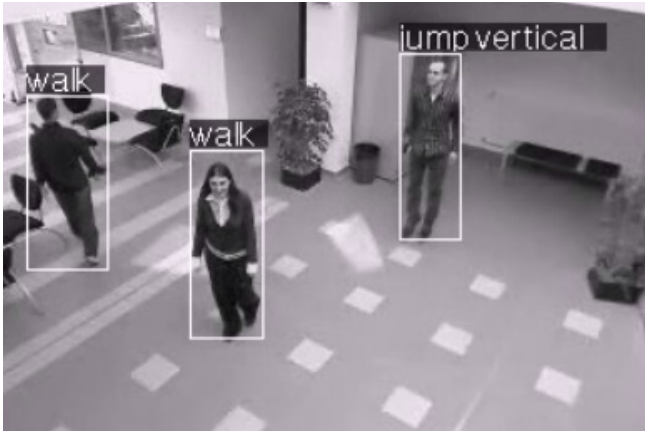
Module en cours de portage sur la plateforme : reconnaissance de comportements humains
