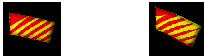
FIGURE 16. Test de flexion dans le cas d'une force \mathbf{F} = (0.0, -2.0, 0.0) (à gauche) ( resp. (0.0, -4.0, 0.0) (à droite)). Eléments finis en jaune et système masses-ressorts en rouge.
