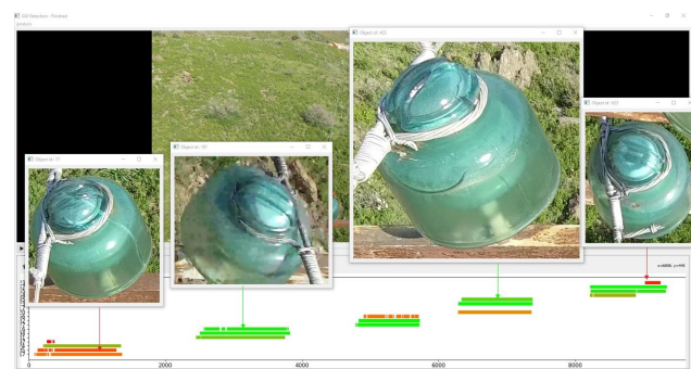
FIGURE 7 – En abscisse on présente la "timeline" de la vidéo. Chaque objet détecté est représenté par une barre colorée en fonction de sa normalité (vert=normal, rouge=anormal). L'utilisateur peut alors cliquer sur la barre pour visualiser l'image représentative de la tracklet considérée afin de l'étudier.
