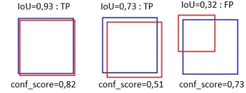
FIGURE 3 – Illustration du calcul de l'IoU et la prédiction ainsi que du score de confiance prédit par l'algorithme.
