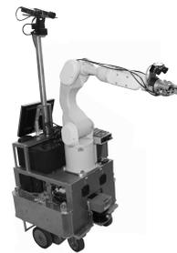
Figure 1 – Bras Robotique PA10-6C : JIDO
