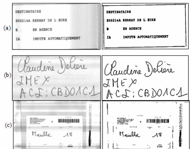
Figure 3 - Binarisation adaptative par la méthode de Sauvola, (a) Image CHC, fenêtre 7x7, (b) Image CIM, fenêtre 9x9, (c) Image 'Insert' fenêtre 15x15.
