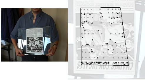
Figure 5 – Trame d'une séquence vidéo, et ses points de référence. Le cadre représente J_0 , les points d'intérêt sont en noir, les points réguliers en gris.
