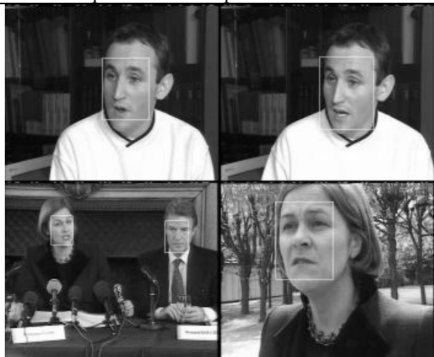
Figure 6 : Résumé « visage ». Les visages détectés sont indiqués par un cadre blanc. Plusieurs visages peuvent être détectés sur une image.
