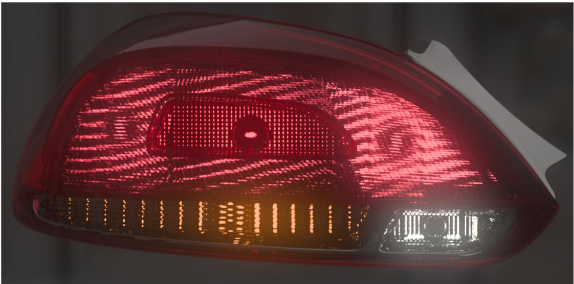
FIGURE 1.4 – *Prototype virtuel d'un produit Valeo* – Ce produit, phare arrière de voiture, est composé de nombreux phénomènes optiques à simuler. En premier lieu, le produit reflète l'environnement. En second lieu, différents types d'éclairage (feu stop, feu de recul, feu de signal) sont chacun associés à un visuel différent. La somme de ces phénomènes donne l'aspect global du produit.
