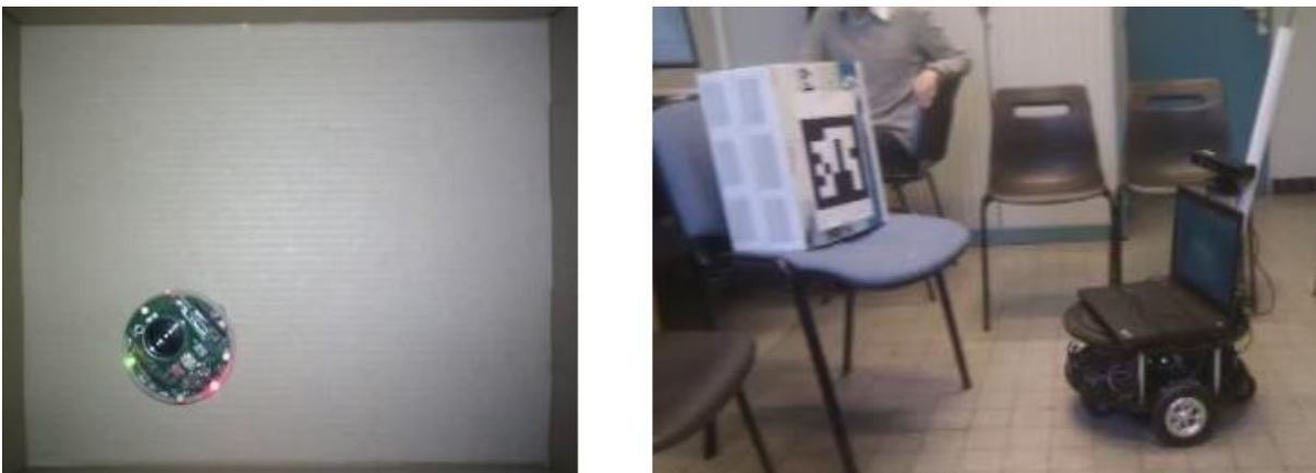
FIGURE 10.2 – Implémentation de nos mécanismes dans des robots. À gauche, le robot e-puck dans le box world [52]. L'implémentation a été réalisé avec Laurent Hu. À droite, le robot Eddie. La proie est représentée par un QR-code. L'implémentation a été réalisée par Christian Wolf et Martin Kodys, de l'équipe IMAGINE 10 .
