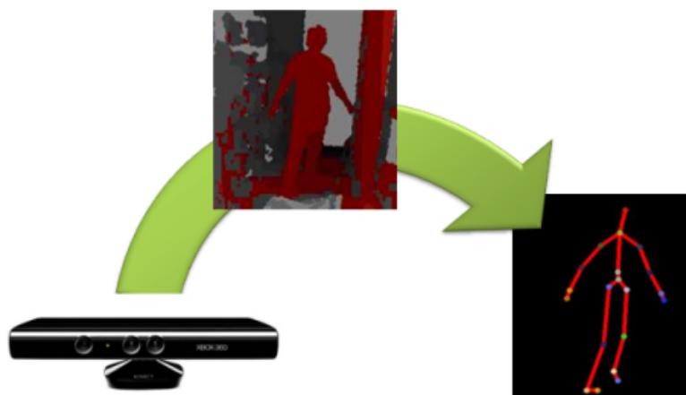
FIGURE 3.4 – Capture de mouvements sans marqueur avec un Kinect™.
