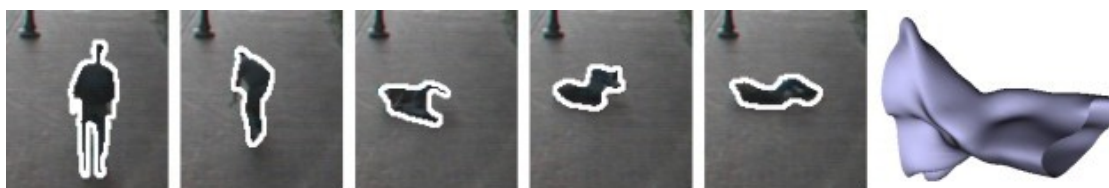
FIGURE 2.8 – Représentation du volume spatio-temporel par stéréo-association des points du contour de la silhouette extraite à chaque image, afin de créer une surface 3D. (©Yilmaz et Shah [158])
