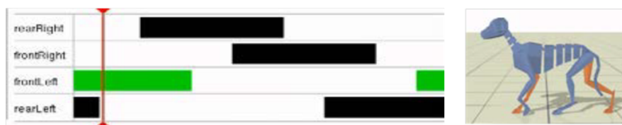
Figure 2: Cycle de locomotion: les barres représentent la phase de vol.
