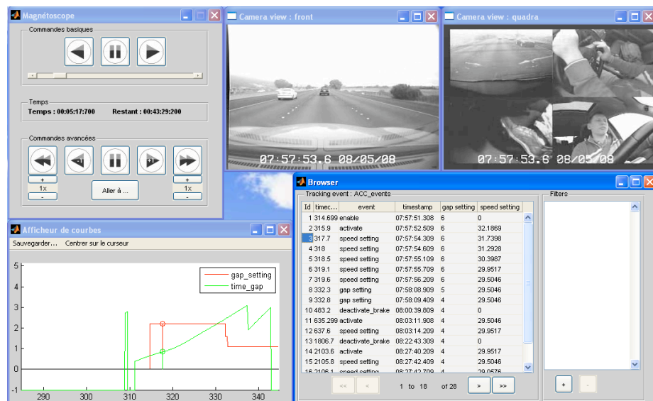
FIGURE 7.2 – Visualisation synchronisée de courbes de données, de vidéos et d'événements. Application développée avec le framework BIND.
