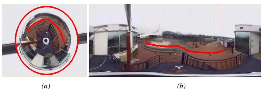
Figure 122 : Trajectoire d'un objet en mouvement calculé à partir de la vue omnidirectionnelle de la caméra en position de repos (a) et sa projection dans le développement cylindrique (b)
