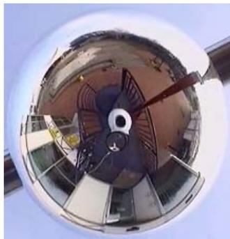
Figure 3 : Capture d'une image panoramique en utilisant un miroir sphérique
