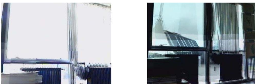
*Figures 6 : Image de gauche : Gain fixe, l'extérieur apparaît très largement saturée. Image de droite : Gain automatique, l'extérieur est visible mais on observe des « coutures »*
