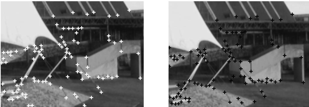
Figure 100 : Détection des points d'intérêts dans deux images avec le détecteur de Harris
