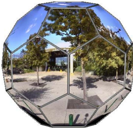
Figure 45 : Exemple de projection d'une sphère sur un icosaèdre tronqué
