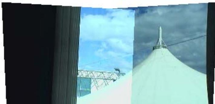
Figure 68 : Gain automatique, l'extérieur est visible mais présence de couture
