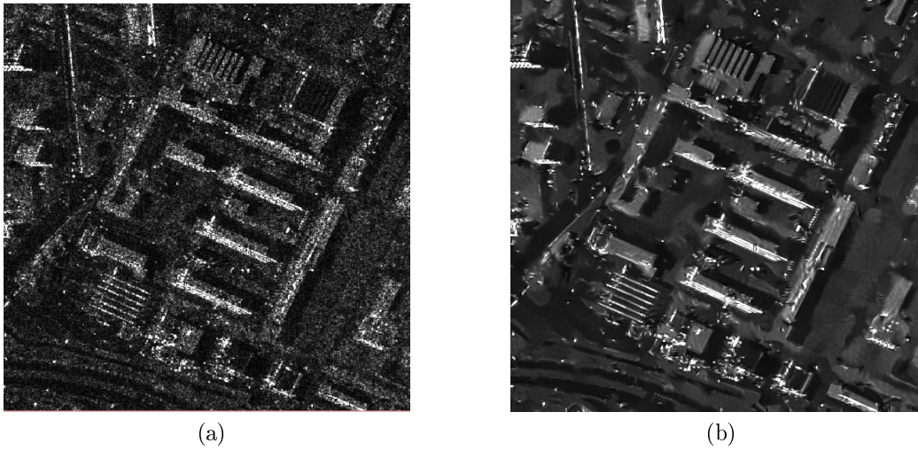
FIGURE 3.13: Résultat du filtrage de l'image radar en utilisant l'algorithme décrit dans [Deledalle 09] : (a) - Image originale. (b) - Image filtrée.
