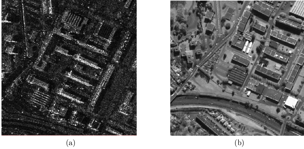
FIGURE 3.9: Résultat du recalage en utilisant le MNT lors de la projection : (a) - Image radar. (b) - Image optique projetée en géométrie radar.
