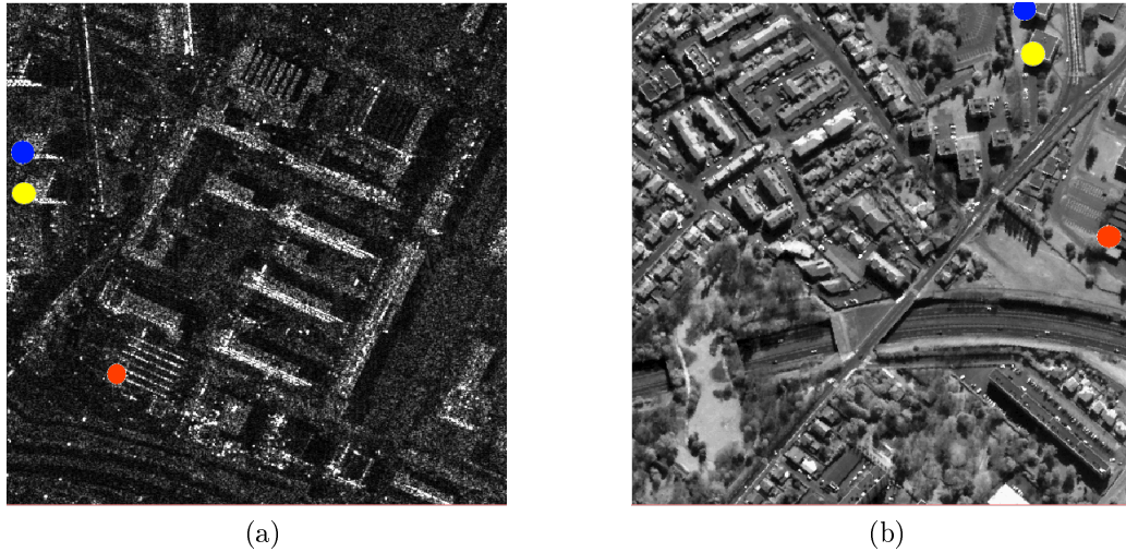
FIGURE 3.8: Résultat du recalage en utilisant une même valeur d'altitude pour tous les points : (a) - Image radar. (b) - Image optique projetée en géométrie radar. Des points de même couleur ont été rajoutés manuellement pour donner une idée sur le décalage.
