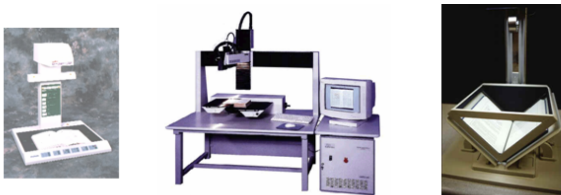
Figure 1.1 : Trois types de scanners ; respectivement de gauche à droite : Scanners sans vitre, Scanner avec lumière froide, Scanner avec plateau pour préserver la reliure du livre
