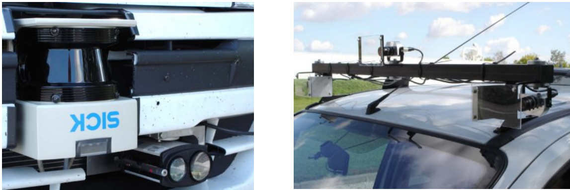
Figure 29 : Système de perception : télémètre laser et caméras.
