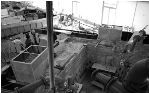
Figure 1.9. Vision d'ensable du modèle hydraulique 3D de la confluence des torrents
