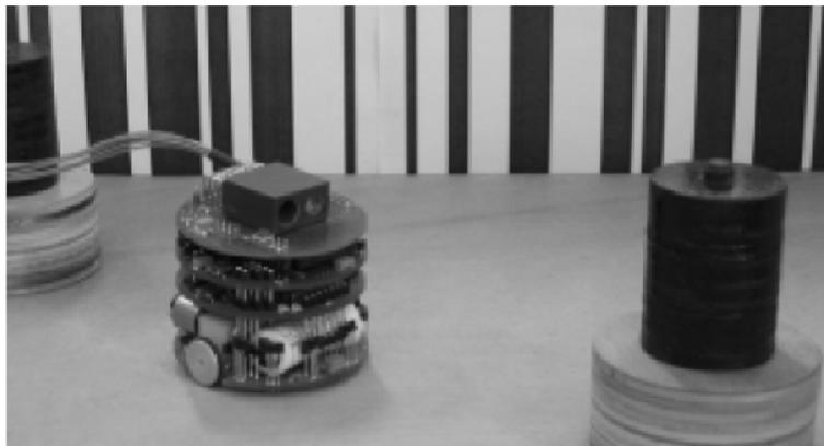
FIG. II.1 – Expérience d’évitement d’obstacles avec le robot Khepera. Ce dernier doit apprendre à utiliser le signal fourni par une caméra linéaire pour détecter les obstacles et les éviter (principe du flot optique). Les murs sont recouverts de bandes blanches et noires de largeur aléatoire. Cette expérience est inspirée de celle réalisée par Floreano et Mattiussi (2001).
