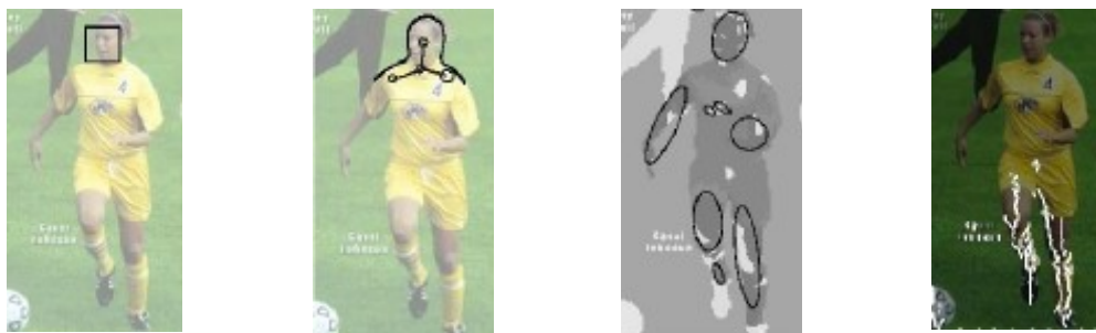
(a) détection du visage (b) détection des épaules d'après un contour actif (c) blobs de teinte chair (d) axe médian des jambes
