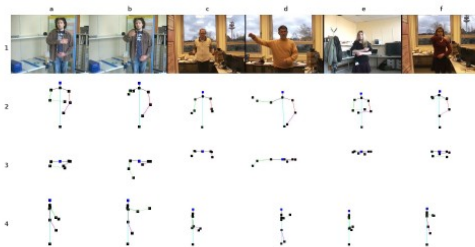
Figure 67 : Suivi 3D en monoculaire avec des poses difficiles incluant les occultations, les fonds texturés et les environnements non contraints (lumière et vêtements) [Noriega P. b].
