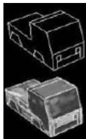
(b) Le modèle basé contour et apparence 3D du véhicule de transport, pour la classification.
