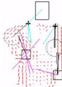
(b) Image des gradients « robustes » - Détection des mains par la teinte chair (carrés), gradients robustes en tirets fins déterminant la direction globale (segments) des bras et avant-bras, à partir des épaules (croix) et des mains, et qui se croisent au niveau du coude (cercle).
