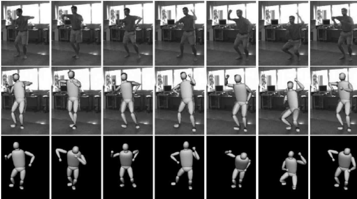
Figure 37 : Suivi monoculaire en 3D. Les améliorations sur le ré échantillonnage du filtre à particules offrent un environnement peu contraint mais pas encore assez robuste ([Sminchisescu C., Triggs B. 03a], [Sminchisescu C., Triggs B. 03b], [Noriega P. a]).
