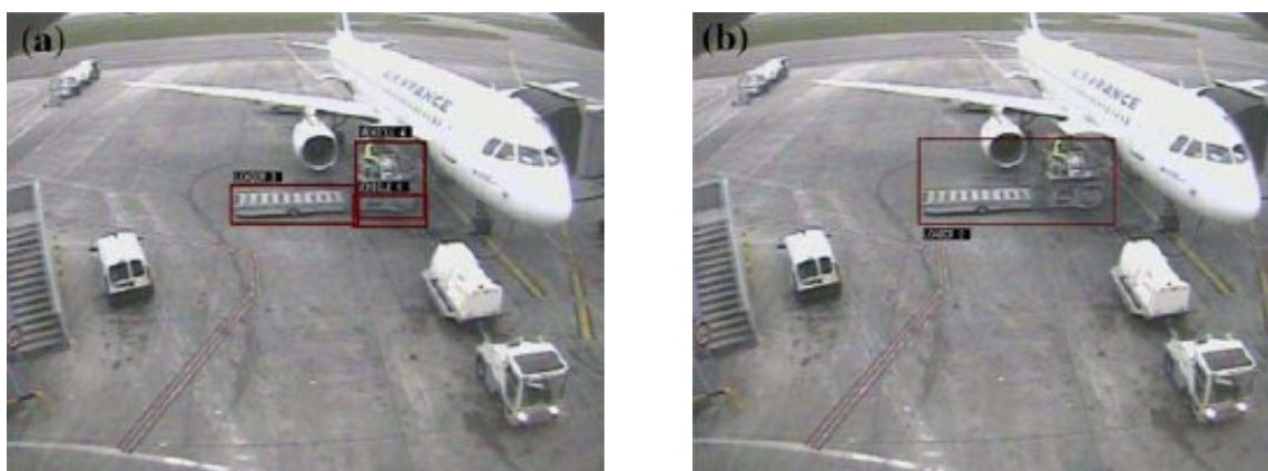
(a) Avant le suiveur global, un véhicule de (b) Après le suiveur global, le véhicule de chargement est détecté comme plusieurs objets chargement est correctement détecté comme un mobiles (sur détection). seul objet mobile.
