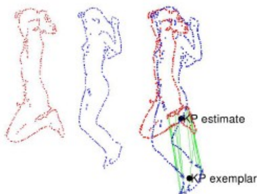
Figure 32 : « shape context » - localisation des articulations. Les points échantillonnés le long de la silhouette exemple (à gauche) et de test (au centre) sont mis en correspondance ([Mori G., Malik J.], [Noriega P. a]).
