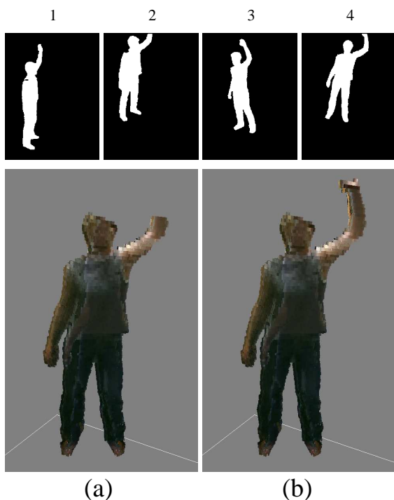
Figure 7 – Estimation voxelique de la forme d'une personne en mouvement : (a) algorithme de base de SFS ; (b) notre algorithme.
